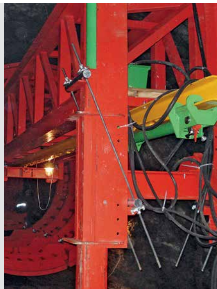
podizanje i spužanje kao i hidraulični cilindri za manipulaciju elemenata zidne i oplate za ploče
